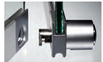
En el mecanismo patentado de pestillo de seguridad Secura, un bulón en forma de L integrado en la hoja delantera se encaja en el cerradero de la hoja posterior, evitando así la separación forzosa de las dos hojas. (A)
